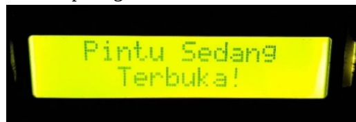
Gambar 17. Hasil pengujian LCD 16x2 I2C
