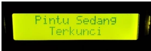
Gambar 18 Hasil pengujian LCD 16x2 I2C 2
